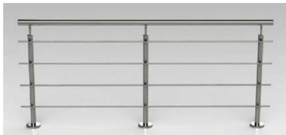
Техническое описание: Ограждение из нержавеющей зеркальной стали марки AISI 304, поручень диаметром 50,8\*1,5 мм, стойка диаметром 38\*1,5 мм, ригель диаметром 16\*1,5 мм - 4 шт. Высота перил 950 мм, поручень и ригель непрерывны на поворотах и маршах.
