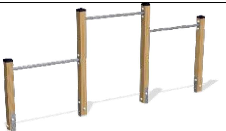
Технические параметры: Сделаны из пропитанной под давлением хвойных пород древесины, полностью сертифицированной по стандарту FSC. Используемый размер бруса: 95x95мм. Захваты для рук выполнены из гальванизированной стали диаметром не менее 38 мм, толщина стенки не менее 2мм. Все соединения закрываются заглушками выполненными из полиамида.
