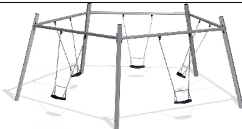
Технические параметры: Пять центральных опор выполнены из предварительно оцинкованной с порошковым покрытием стали диаметром не менее 100 мм, толщина стенки не менее 3 мм. Сиденье выполнено из полипропилена, покрытого эластичным противоскользящим каучуком (TPE). Цели изготовлены из гальванизированной стали. Все соединения закрываются заглушками выполненными из полиамида.
