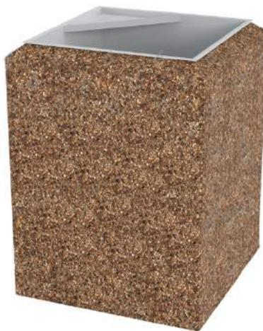
Технические параметры: Бетонная урна с фактурой московский гравий. Комплектуется оцинкованным ведром с пепельницей. Размеры. Длина: 450 мм. Ширина: 450 мм. Высота: 600 мм. Вес изделия: 130 кг. Проектный класс бетона по прочности на сжатие B25 кг/см<sup>2</sup>. Отпускная прочность 90%. Фактическая отпускная прочность бетона 46,5 Мпа. Морозостойкость F 150. Водонепроницаемость W 4. Содержание радионуклидов Бк/кг I класс (до 370Бк/кг).
