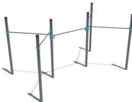
Комплекс состоит из шести опорных столбов высотой 2600мм, и пяти перекладин для подтягиваний длиной 1758мм, которые крепятся к опорным столбам припомощи хомутов на высоте 2шт. - 2200мм, 2шт. - 2000мм, 1шт. - 1900мм. Длина комплекса не более 4700 мм. Покрытие оборудования- горячее цинкование, окрашивание навесных элементов и хомутов- RAL 9005 (черный муар)
