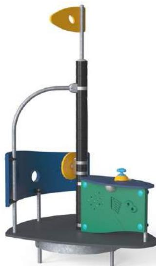
Технические параметры: Опоры-трубы изготовлены из низкоуглеродистой оцинкованной стали, толщиной стенок не менее 2 мм. Полы, ступени и другие поверхности изготовлены из ламината высокого давления толщиной не менее 18 мм типа HPL, Все соединения закрываются заглушками выполненными из полиамида
