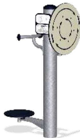
Техническое описание: Опоры выполнены из предварительно оцинкованной стали диаметром не менее 101,6 мм, толщина стенки не менее 2мм. Панели выполнены из полиэтилена высокой плотности HDPE EcoCore™ толщиной не менее 19 мм. Имеют высокую износостойкость в любых погодных условиях. Захваты для рук покрыты термопластичным полиуретаном (TPU). Не содержат вредных добавок и материалов. Пожизненная гарантия.
