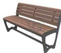
Технические параметры: материалы: каркас – листовая сталь 6 мм, дерево – сосна 35х90 мм, покрытие древесины – водостойкая пропитка и водостойкий лак, цвет каркаса – черный полимерно-порошковое окрашивание, фурнитура – оцинкованная, стандартный цвет серебристый или черный.
