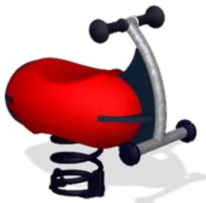
Технические параметры: Качалка на стальной пружине толщиной не менее 18 мм. Сиденье из полиэтилена средней плотности. Захваты для рук покрыты термопластичным полиуретаном (TPU). Внутренняя часть сделана из пластиковой вставки (полипропилен) и квадратного стального сердечника. Опоры для ног из гальванизированной стали диаметром не менее 76 мм и толщиной стенки 3,65 мм. Все соединения закрываются заглушками выполненными из полиамида.
