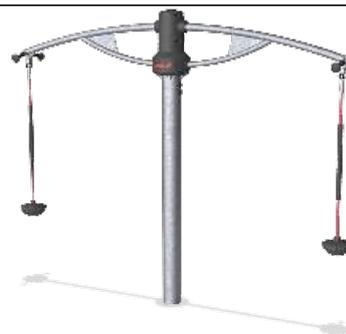
Опора выполнена из предварительно оцинкованной стали диаметром не менее 159 мм, толщина стенки не менее 4 мм. Основная балка из предварительно оцинкованной стали диаметром не менее 60,3 мм, толщина стенки не менее 3 мм. Поддержка основной балки выполнена из предварительно оцинкованной стали диаметром не менее 48,3 мм, толщина стенки не менее 3 мм. Высота нижней части сиденья над землей 0,71 м. Все соединения закрываются заглушками выполненными из полиамида.
