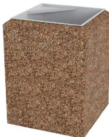
Технические параметры: Бетонная урна с фактурой московский гравий. Комплектуется оцинкованным ведром с пепельницей. Размеры. Длина: 450 мм. Ширина: 450 мм. Высота: 600 мм. Вес изделия: 130 кг. Проектный класс бетона по прочности на сжатие В25 кг/см<sup>2</sup>. Отпускная прочность 90%. Фактическая отпускная прочность бетона 46,5 Мпа. Морозостойкость F 150. Водонепроницаемость W 4. Содержание радионуклидов Бк/кг I класс (до 370Бк/кг).
