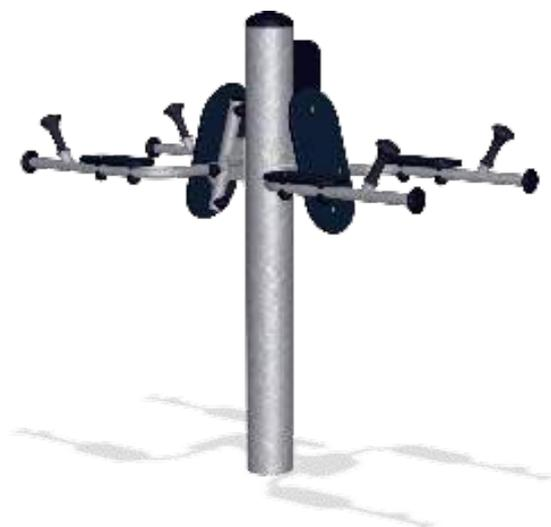
Техническое описание: Опоры выполнены из предварительно оцинкованной стали диаметром не менее 101,6 мм, толщина стенки не менее 2мм. Панели выполнены из полиэтилена высокой плотности HDPE EcoCore™ толщиной не менее 19 мм. Имеют высокую износостойкость в любых погодных условиях. Захваты для рук покрыты термопластичным полиуретаном (TPU). Не содержат вредных добавок и материалов. Пожизненная гарантия.
