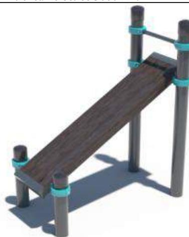
Технические параметры: Комплекс состоит из четырех опорных столбов высотой: 2шт.–1500мм, 2шт.–400мм и наклонной скамьи для упражнений на пресс. ДПК брус скамьи крепится к опорным столбам при помощи хомутов и перекладин длиной 500мм на высоте: в верхней части 1000мм от поверхности основания, в нижней части 275мм от поверхности основания. Перекладина для удержания руками крепится на высоте 1350мм. Длина рабочей поверхности скамьи составляет 1500мм, ширина-400мм. Длина комплекса не более 1300 мм.
