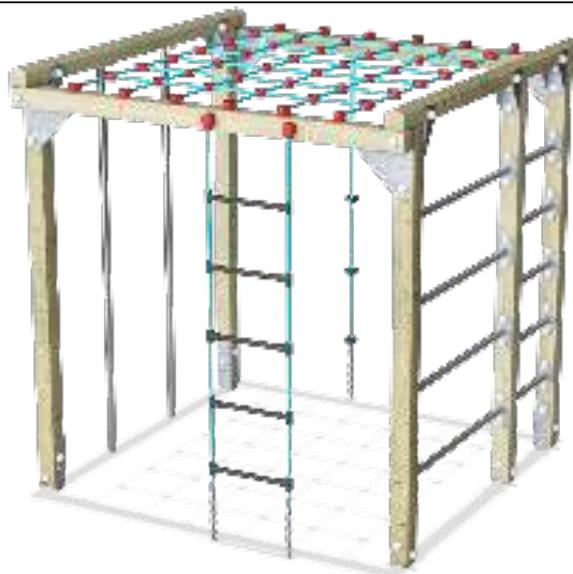
Технические параметры: Сделаны из пропитанной под давлением хвойных пород древесины, полностью сертифицированной по стандарту FSC. Используемый размер бруса: 95x95мм. Тросы диаметром 16 мм, сплетенные из 4 скрученных полиамидных жил, каждая со стальным гальванизированным сердечником в полипропиленовой оболочке. Жилы скручены вокруг центрального полипропиленового сердечника. Полная расчетная нагрузка тросов 18,8к кН. Все соединения закрываются заглушками выполненными из полиамида.
