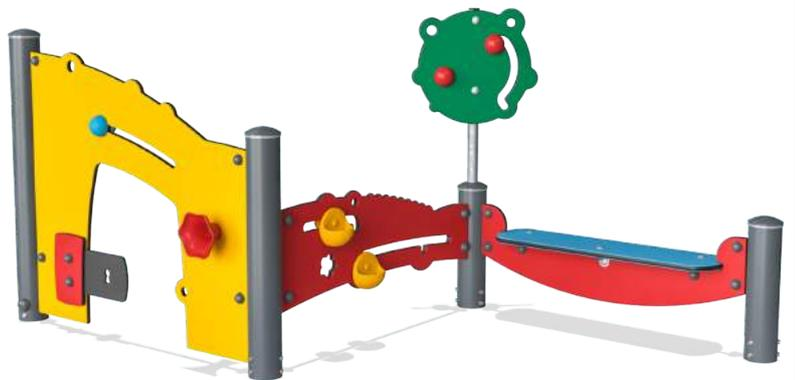
Технические параметры: Опоры выполнены из предварительно оцинкованной с порошковым покрытием стали диаметром не менее 101,6 мм, толщина стенки не менее 2мм. Панели выполнены из полиэтилена высокой плотности HDPE EcoCoge™ толщиной не менее 19 мм. Имеют высокую износостойкость в любых погодных условиях. Не содержат вредных добавок и материалов. Пожизненная гарантия. Все соединения закрываются заглушками выполненными из полиамида.
