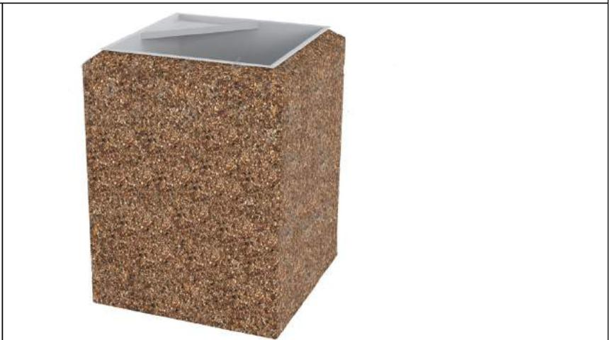
Технические параметры: Бетонная урна с фактурой московский гравий. Комплектуется оцинкованным ведром с пепельницей. Размеры. Длина: 450 мм. Ширина: 450 мм. Высота: 600 мм. Вес изделия: 130 кг. Проектный класс бетона по прочности на сжатие В25 кг/см<sup>2</sup>. Отпускная прочность 90%. Фактическая отпускная прочность бетона 46,5 Мпа. Морозостойкость F 150. Водонепроницаемость W 4. Содержание радионуклидов Бк/кг I класс (до 370Бк/кг).
