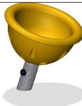
Технические параметры: Чаша изготовлена из полиэтилена средней плотности, центробежного формования. Чаша крепится к опоре посредством специального металлического подшипника, обеспечивающего вращение чаши вокруг оси. Труба опоры диаметром 101.6мм и толщиной стенок 2.9 мм изготовлена из гальванизированной стали. Все соединения закрываются заглушками выполненными из полиамида.
