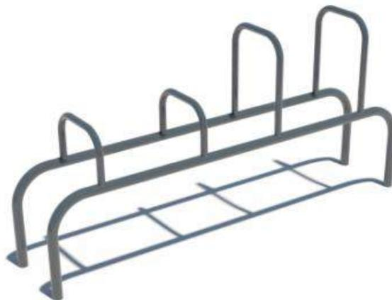
Комплекс представляет собой металлическую конструкцию длиной 2040 мм, шириной 400 мм и высотой 1000 мм. Комплекс имеет четыре полукольца высотой: 2шт. - 250мм, 2шт. - 500мм. Расстояние между равновеликими кольцами - 500мм, между кольцами разного размера- 394мм. Длина комплекса не более 2100 мм. Покрытие оборудования- горячее цинкование, окрашивание навесных элементов и хомутов- RAL 9005 (черный муар)
