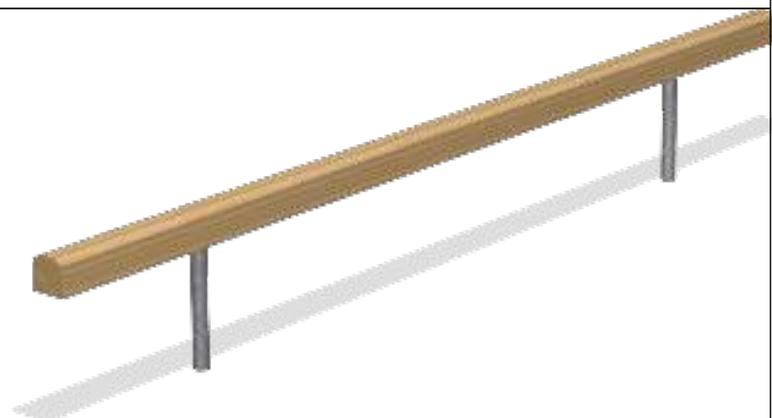
Технические параметры: Сделаны из пропитанной под давлением хвойных пород древесины, полностью сертифицированной по стандарту FSC. Используемый размер бруса: 95x95мм. Опоры изготовлены из гальванизированной стали диаметром не менее 38 мм и толщиной стенок не менее 2 мм методом горячего цинкования. Все соединения закрываются заглушками выполненными из полиамида.
