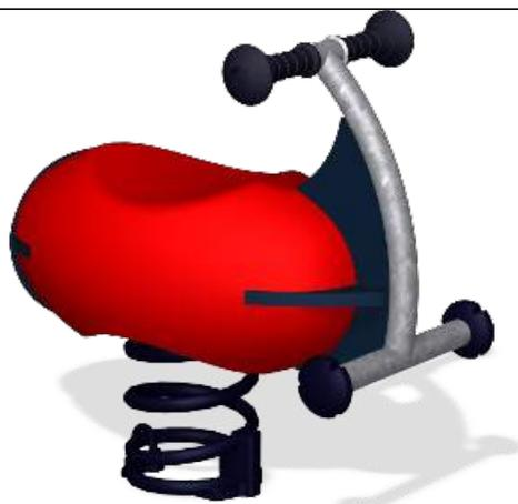
Технические параметры: Качалка на стальной пружине толщиной не менее 18 мм. Сиденье из полиэтилена средней плотности. Захваты для рук покрыты термопластичным полиуретаном (TPU). Внутренняя часть сделана из пластиковой вставки (полипропилен) и квадратного стального сердечника. Опоры для ног из гальванизированной стали диаметром не менее 76 мм и толщиной стенки 3,65 мм. Все соединения закрываются заглушками выполненными из полиамида.
