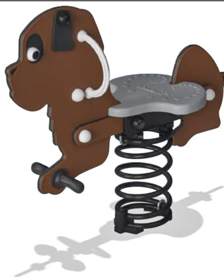
Технические параметры: Качалка на стальной пружине толщиной не менее 18 мм. Панели выполнены из полиэтилена высокой плотности HDPE EcoCore™ толщиной не менее 19 мм. Имеют высокую износостойкость в любых погодных условиях. Не содержат вредных добавок и материалов. Пожизненная гарантия. Сиденье выполнено из Ekogrib – слоистый полиэтилен с высокой плотностью имеющий противоскользящий резиновый слой. Все соединения закрываются заглушками выполненными из полиамида.
