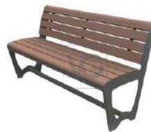
Технические параметры: материалы: каркас – листовая сталь 6 мм, дерево – сосна 35x90 мм, покрытие древесины – водостойкая пропитка и водостойкий лак, цвет каркаса – черный полимерно-порошковое окрашивание, фурнитура – оцинкованная, стандартный цвет серебристый или черный.
