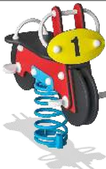
Технические параметры: Качалка на стальной пружине толщиной не менее 18 мм. Панели выполнены из полиэтилена высокой плотности HDPE EcoCoge™ толщиной не менее 19 мм. Имеют высокую износостойкость в любых погодных условиях. Не содержат вредных добавок и материалов. Пожизненная гарантия. Подставка для ног и захваты для рук сделана из твердого пластика полиамида (PA). Все соединения закрываются заглушками выполненными из полиамида.
