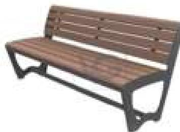
Технические параметры: материалы: каркас – листовая сталь 6 мм, дерево – сосна 35x90 мм, покрытие древесины – водостойкая пропитка и водостойкий лак, цвет каркаса – черный полимерно-порошковое окрашивание, фурнитура – оцинкованная, стандартный цвет серебристый или черный.
