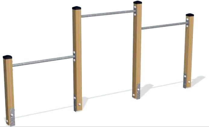
Технические параметры: Сделаны из пропитанной под давлением хвойных пород древесины, полностью сертифицированной по стандарту FSC. Используемый размер бруса: 95x95мм. Захваты для рук выполнены из гальванизированной стали диаметром не менее 38 мм, толщина стенки не менее 2мм. Все соединения закрываются заглушками выполненными из полиамида.
