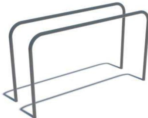
Технические параметры: Комплекс состоит из двух жердей. Жерди брусьев расположены параллельно. Расстояние между внутренними поверхностями жердей 500мм, рабочая поверхность-1800мм. Жерди брусьев симметрично изогнуты под углом 90 градусов, высота-1200мм от поверхности основания. Длина комплекса не более 2100 мм.
