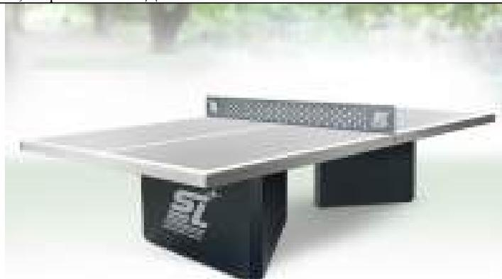
Техническое описание: бетонный антивандальный теннисный стол для открытых площадок. Цвет: комбинированный серый и черный. Игровое поле: камень Super Stone, толщина 60 мм. Покрывает специальной пропиткой. Сетка: встроенная, металлическая, 3 мм Опоры: бетонные, армированные. Размер (международный стандарт): длина 274 см, ширина 152,5 см, высота 76 см. Вес: 1280 кг.
