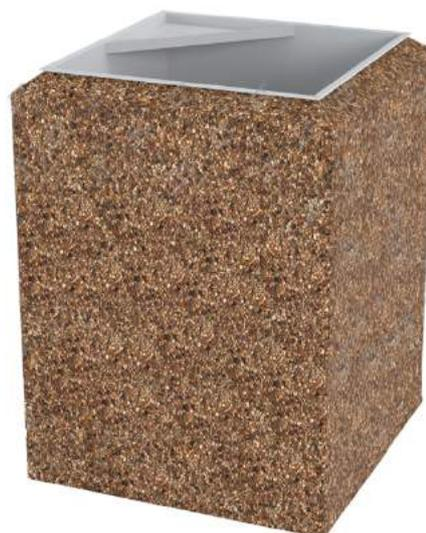
Технические параметры: Бетонная урна с фактурой московский гравий. Комплектуется оцинкованным ведром с пепельницей. Размеры. Длина: 450 мм. Ширина: 450 мм. Высота: 600 мм. Вес изделия: 130 кг. Проектный класс бетона по прочности на сжатие В25 кг/см<sup>2</sup>. Отпускная прочность 90%. Фактическая отпускная прочность бетона 46,5 Мпа. Морозостойкость F 150. Водонепроницаемость W 4. Содержание радионуклидов Бк/кг I класс (до 370Бк/кг).
